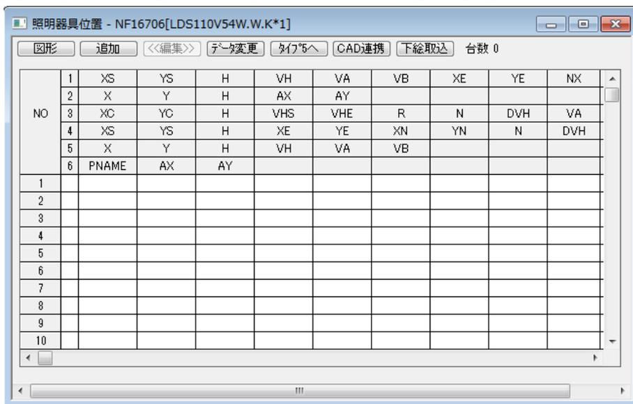
(20) [器具位置追加] の画面が表示されます。1の[格子(器具中心+角度)]を選択してください。「NF16706」は点Dから点Eまでの範囲でX方向に5台、Y方向に2台、等間隔に配置します。したがって、XS=1、YS=1、H=2.8、XE=14、YE=8.5、NX=5、NY=2 となります。数値は半角で入力してください。全て入力が終わると下の画面になります。[OK] をクリックしてください。
