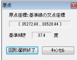
傾きの軸を指定した場合は画面上の基準傾きに角度が表示されます。選択が完了後 [図形選択終了] をクリックしてください。
